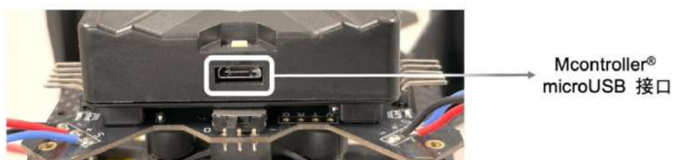
无人机飞控（带外壳）程序烧录接口
